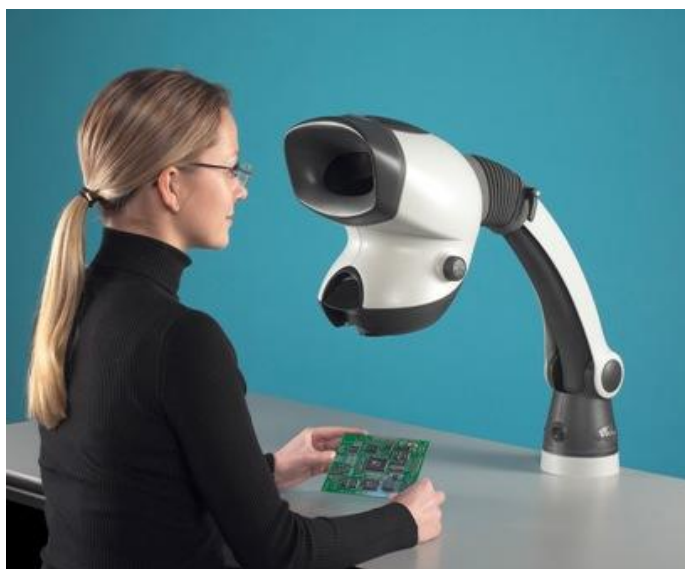
Mantis Compact на универсальном штативе. Универсальный сбалансированный штатив. Гибкость и свобода перемещения оптической головки. Крепление на струбцине.
